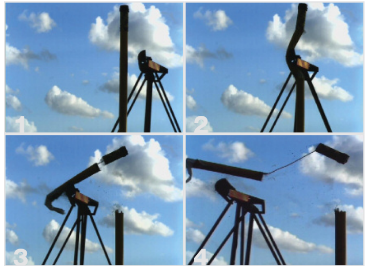
На изображениях последовательно показан момент ударного воздействия на мачту Pollite при скорости 140 км/ч.
